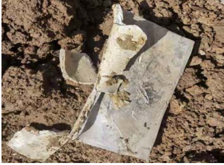
图 2 厚度 20 mm 炸药爆炸焊接后材料状态
