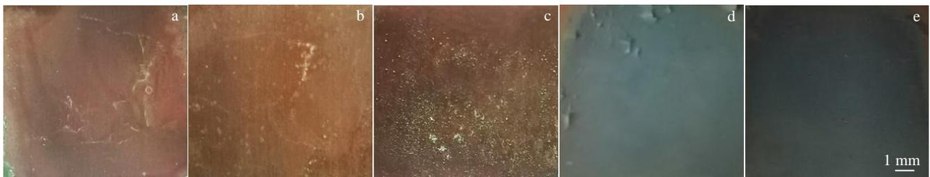
图 5 Cu-4%Ti 合金在含不同  $S^{2-}$  浓度的  $3.5\% \text{NaCl}$  溶液中浸泡 12 d 的宏观形貌
