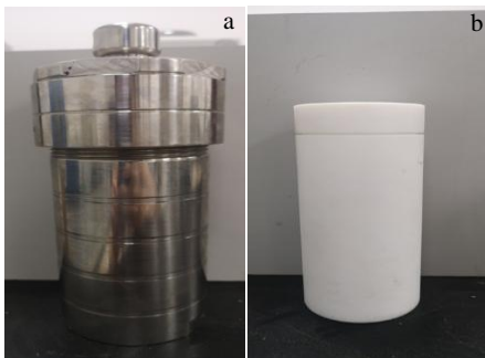
图 2 浸泡腐蚀容器
