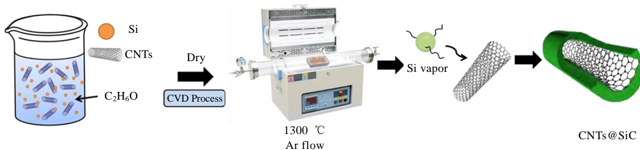
图 1 CNTs@SiC 复合材料的合成路线图
