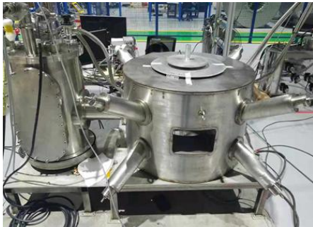
图 5 线圈杜瓦组装测试
