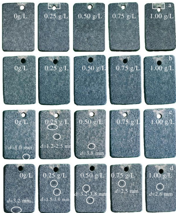
图 9 盐雾腐蚀不同时间后的氧化膜
