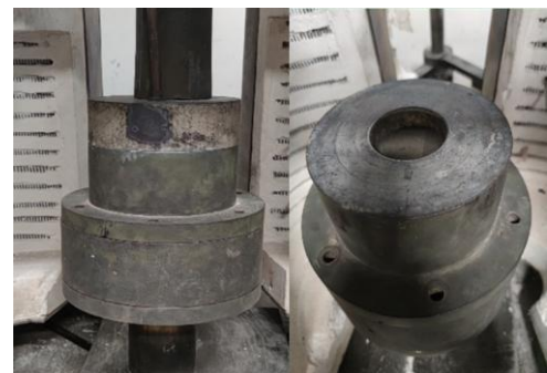
图 3 Ni/Al 微叠层复合板气压胀形装置
