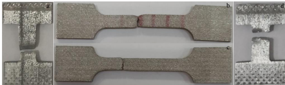
图 13 FEAM 增材试样 Z 方向拉伸断裂试样
