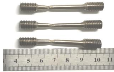
图 4 焊接接头高温拉伸试验断裂位置
