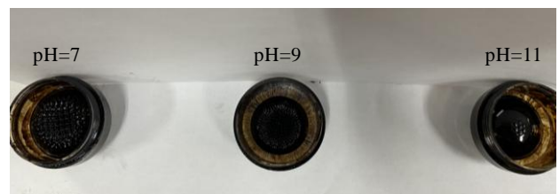
图 6 不同 pH 值包覆磁性液体沉降现象
