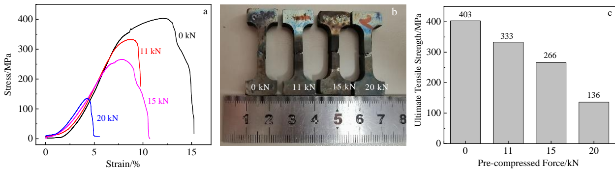
图 8 不同残余应力的焊缝金属试样的高温（650 °C）拉伸性能
