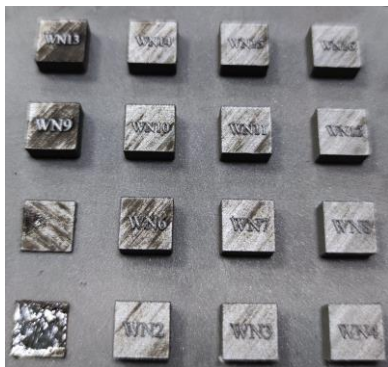
图 3 激光粉末床熔融制备的钨镍试样
