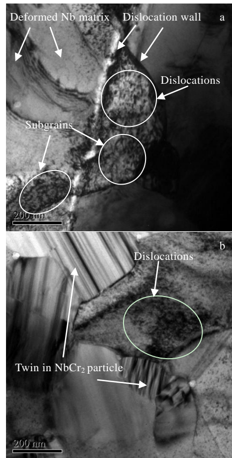
图 4 Laves 相 NbCr 2 /Nb 两相合金在 1200 °C、0.001 s -1 条件下变形的微观组织
