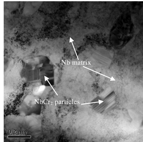
图 3 Laves 相 NbCr 2 /Nb 两相合金未变形的微观组织
