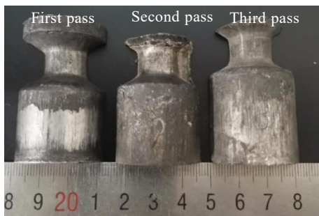
图 2 不同道次往复挤压试样宏观形貌
