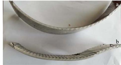
图 4 Ti/Al 复合板宏观形貌
