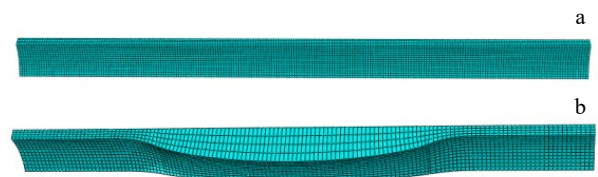
图 21 直动脉网格模型和斑块网格模型
