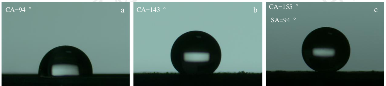
图 3 水滴在 PDMS、FPD 和 FSPD 的静态接触角图。
