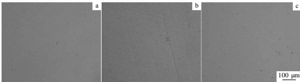
图 6 不同配碳量质量分数的 WC-0.5Co-0.73 VC/Cr<sub>3</sub>C<sub>2</sub> 合金烧结试样金相照片
