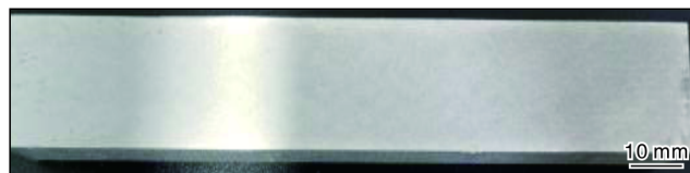
图 6 工艺改进后 TC17 钛合金锻件低倍组织照片
