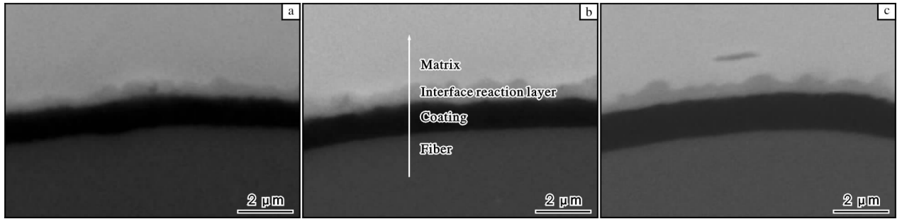
图6 不同热压温度下得到的SiC f /TB8复合材料纤维与基体界面反应层的形貌
