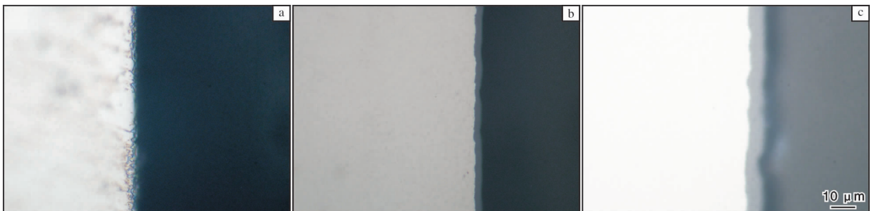
图8 锆-4合金内管均匀腐蚀不同时间后横截面的金相照片
