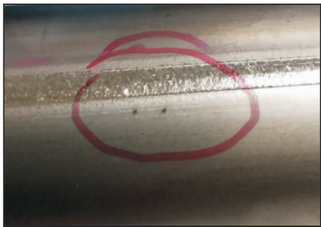
图 1 钛焊管表面典型黑斑形貌
