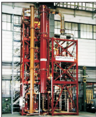
图 3 回收 HCl 的高压旋转蒸馏设备
