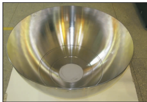
图 17 终加工后的 TC4 钛合金半球壳
