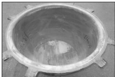
图 14 正反胀形得到的半球壳毛坯件
