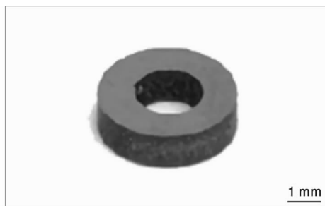
图 4 成品非标微型圆螺母试样照片
