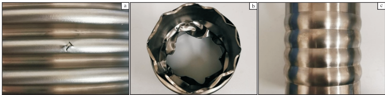
图6 DN85 波纹管的典型缺陷
