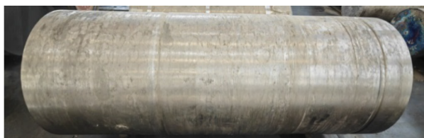
图5 12.8 t 级 TC4 ELI 钛合金铸锭照片
