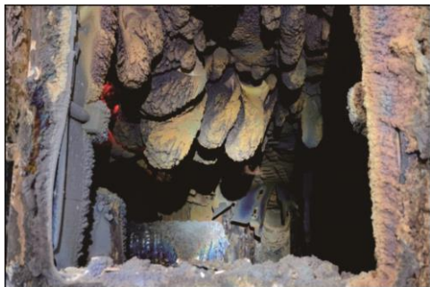
图 11 熔炼室内冷凝罩上的冷凝物照片
