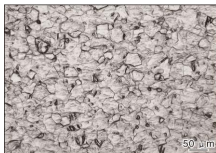
图 1 热轧态 Gr.39 钛合金带卷显微组织
