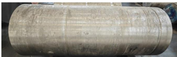
图5 12.8 t 级 TC4 ELI 钛合金铸锭照片
