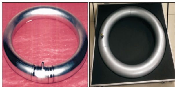
图 7 热推制成形的钛环形气瓶照片
